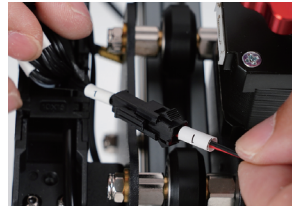
I(2PIN)→Laser Fan Line
