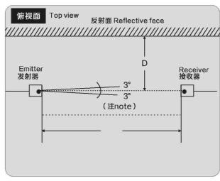
施多德光幕附近存在反射面的干扰时,可能导致内部传感器无法检测,以致于无法完成保护工作。当发射器与接收器距离在0-3时,D不小于0.16m;当间距3-5时,D=LX tanO(0.052)
